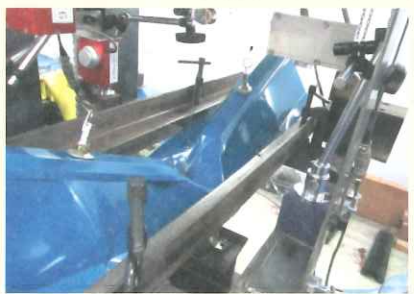
重ね形折板の接合部耐力試験
