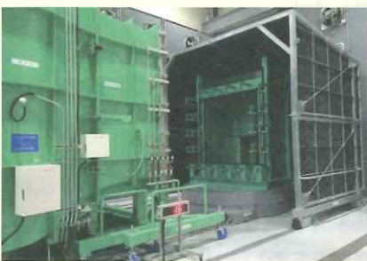
角波の送風散水試験
